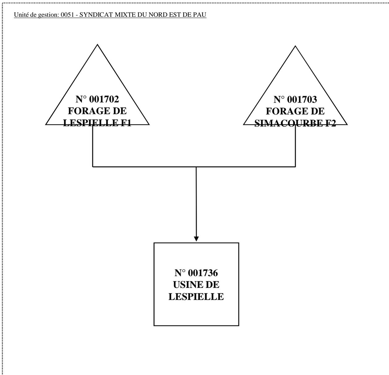
**Légende:** N°: Numéro d'installation - ▲ Captage - ▲ Mélange de captages - □ Station de traitement production
